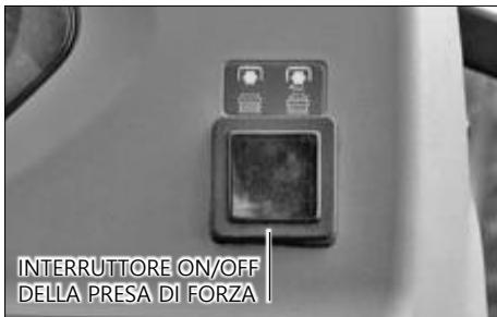
Il funzionamento delle posizioni "automatica" e "manuale" dell'interruttore della PTO è il seguente:
