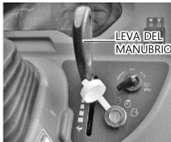
Viene utilizzato per regolare il regime del motore come il pedale dell'acceleratore.
