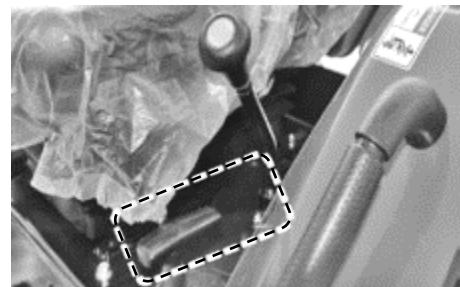
Sollevare la maniglia del freno per impostare il freno di stazionamento. Sollevare leggermente la maniglia del freno di stazionamento fino a premere il pulsante di rilascio del freno di stazionamento. Tenere premuto il pulsante e abbassare completamente la maniglia del freno di stazionamento per rilasciare il freno di stazionamento.
