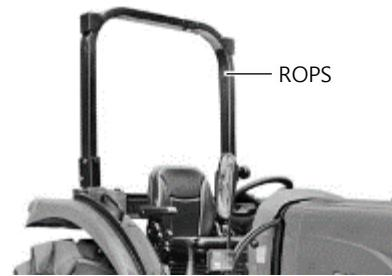
Il telaio di sicurezza ha lo scopo di ridurre i danni di un incidente in caso di ribaltamento, quindi non può impedire un incidente.
