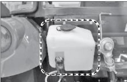
Controllare il livello del liquido lavavetri nel serbatoio di plastica situato sul lato posteriore del trattore.
