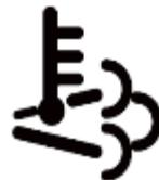
Si accende sul monitor LCD quando la temperatura dei gas di scarico è anomala.
