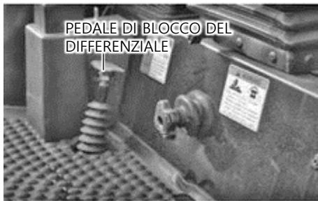
Il bloccaggio del differenziale è un dispositivo che blocca il sistema differenziale per far ruotare le ruote destra e sinistra alla stessa velocità. Questa funzione può essere utilizzata quando le ruote posteriori slittano o una ruota gira.
