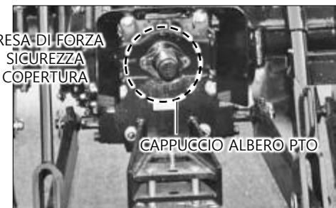
Quando l'albero della presa di forza non viene utilizzato, ingassare l'albero della presa di forza e installare il tappo.
