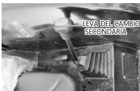
La direzione di marcia può essere selezionata tra la direzione di marcia avanti e la direzione di marcia indietro utilizzando la leva del cambio e la leva del cambio gamma.
