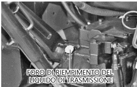
FORO DI RIEMPIMENTO DEL LIQUIDO DI TRASMISSIONE
