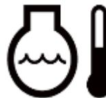
Se la spia del liquido di raffreddamento si accende, il motore è surriscaldato. Arrestare il trattore e controllare quanto segue:
