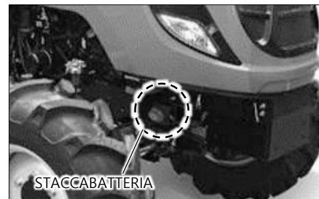
La funzione dello staccabatteria è quella di interrompere l'alimentazione dell'impianto elettrico, interrompendo il collegamento alla batteria. Ciò comporta vantaggi per la sicurezza e il funzionamento del trattore, in particolare:
