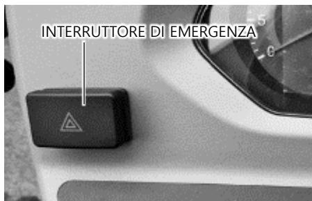
Questo interruttore può essere utilizzato per avvisare gli altri veicoli in caso di malfunzionamento del trattore durante la guida su una strada pubblica. Premendo una volta l'interruttore, le luci di emergenza destra e sinistra lampeggiano. Premendo nuovamente l'interruttore, le luci si spengono.
