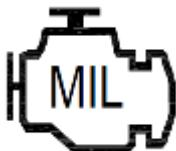
Si accende sul monitor LCD quando il motore non funziona correttamente.
